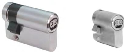
Mechatronischer Schließzylinder mit gekapselter Elektronikbaugruppe nach DIN EN 15684 / DIN 18252 / EN 1303 für den Einbau in Europrofilschlössern nach DIN 18251. Wartungsarm durch kontaktbasierte Spannungsversorgung bei Betätigung mit dem Schlüssel.
