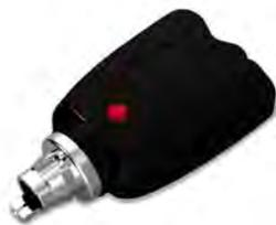
Der Nutzerschlüssel mit integrierter Batterie versorgt die Schließungen während des Öffnungs- und Schließvorgangs mit Energie, um die Zutrittsberechtigung zu überprüfen und im Falle eines berechtigten Zutritts die Schließungen betätigen zu können. Die Programmierung des Nutzerschlüssels erfolgt mittels eines im Schlüssel integrierten NFC-Chips entweder über ein RFID/NFC-basiertes Programmiergerät, NFC-fähiges Smartphone oder virtuell vernetzt über einen Türmanager.
