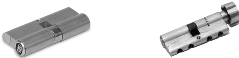
Mechatronische Schließzylinder mit gekapselter Elektronikbaugruppe nach DIN EN 15684 / DIN 18252 / EN 1303 für den Einbau in Europrofilenschlössern nach DIN 18251. Geeignet zum Einbau in Schlösser nach DIN 18250 (Feuer- und Rauchschutz). Wartungsarm durch kontaktbasierte Spannungsversorgung bei Betätigung mit dem Schlüssel.
