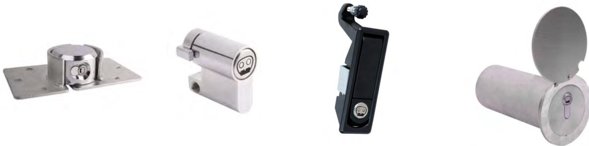
Mechatronische Zylinder und Schließungen für Spezialanwendungen mit gekapselter Elektronikbaugruppe. Diese mechatronischen Sonderlösungen mit integriertem Schließzylinder arbeiten batterieelos und sind somit wartungsarm. Die Spannungsversorgung erfolgt kontaktbasiert durch den Schlüssel, während der Betätigung.
