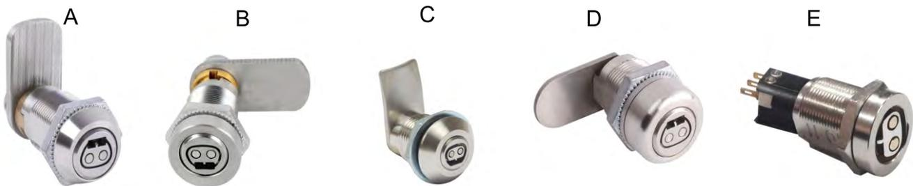
Mechatronische Hebelzylinder mit gekapselter Elektronikbaugruppe. Diese mechatronischen Schließzylinder arbeiten batterieless und sind somit wartungsarm. Die Spannungsversorgung erfolgt kontaktbasiert durch den Schlüssel, während der Betätigung. Die Hebelzylinder sind in Varianten mit unterschiedlichen Gewindedurchmessern, Drehwinkeln und Hebelformen erhältlich. Kundenspezifische Varianten können auf Anfrage geliefert werden.
