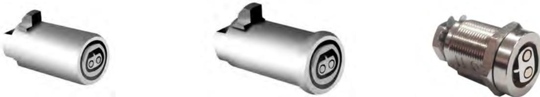
Mechatronische Kompakt-Schließzylinder mit gekapselter Elektronikbaugruppe für den Einsatz in gesicherten Automaten oder Vitrinen. Diese mechatronischen Schließzylinder arbeiten batterieless und sind somit wartungsarm. Die Spannungsversorgung erfolgt kontaktbasiert durch den Schlüssel während der Betätigung.
