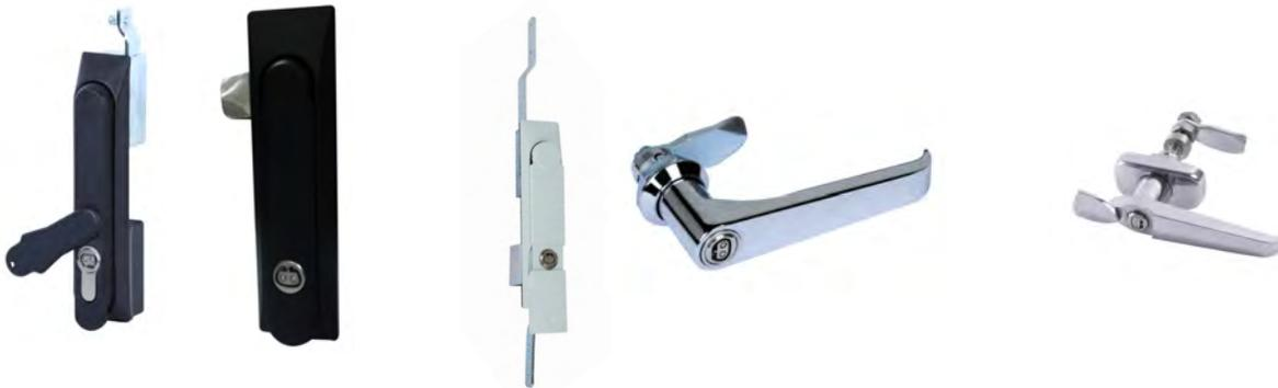
Mechatronische Schwenkhebel, Schaltschrankgriffhebel und L-Griffverriegelungen mit gekapselter Elektronikbaugruppe. Diese mechatronischen Schaltschrankgriffe mit integriertem Schließzylinder arbeiten batterie los und sind somit wartungsarm. Die Spannungsversorgung erfolgt kontaktbasiert durch den Schlüssel während der Betätigung. Diese Verriegelungen sind auch für den Außeneinsatz unter extremen Bedingungen geeignet.
